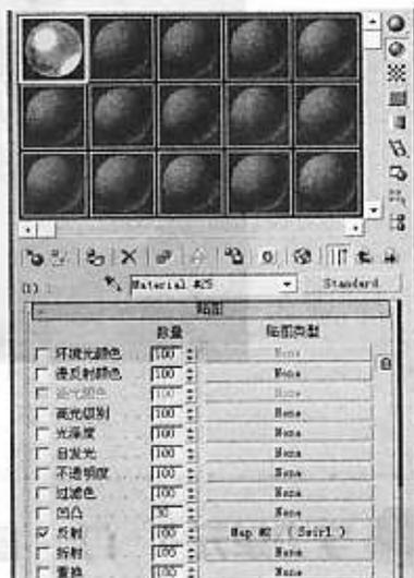
图 2—19 在反射中施加一幅贴图图片
