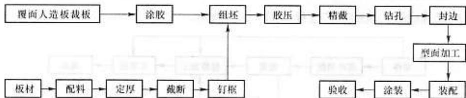
图 3—22 空心板式家具生产工艺流程示意图
