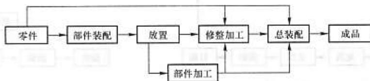
图 3—20 零部件装配成品流程示意图
