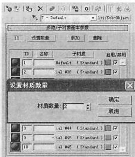
图 2—17 “多维/子对象材质基本参数”下的“设置数目”
